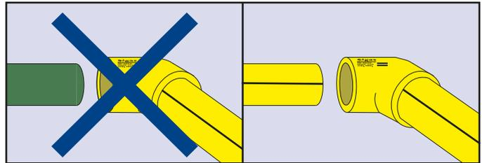
**2.** NO TERMOFUSIONAR SIGAS Thermofusión® con ninguna otra tubería. Usar sólo boquillas y termofusores provistos por el GRUPO DEMA, para asegurar temperaturas, medidas y tolerancias acordes con el sistema SIGAS Thermofusión®.
