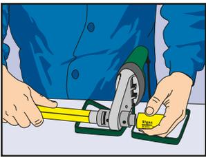
El sistema de unión más confiable: Thermofusión®.
