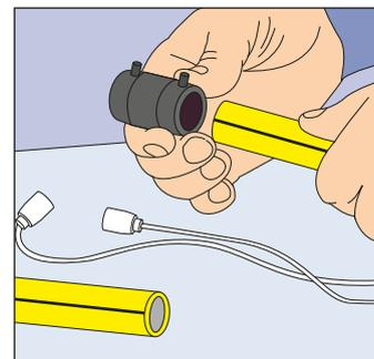
**4.** Una vez introducidos los caños hasta la marca, conectar los bornes de la cupla eléctrica al electrofundidor y seguir las instrucciones del equipo en uso.
