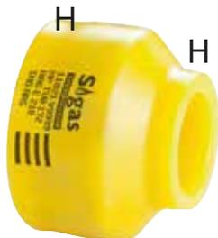
**CUPLAS DE REDUCCIÓN:** Son del tipo **Hembra-Hembra (HH)** con enchufe en ambos extremos. Para instalarlas se requiere el uso de niples del tipo artesanal (hechos en obra) o del tipo con tope, fabricados y comercializados en los diámetros que van desde 25 mm x 20 mm hasta 110 mm x 90 mm.
