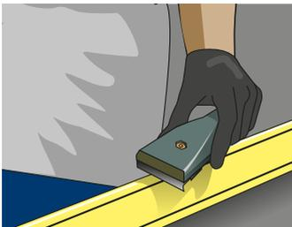
**2.** Raspar la superficie exterior del tubo en el lugar donde se va a fusionar la montura. A continuación limpie el tubo y el interior de la montura con un trapo de algodón o papel tissue y alcohol.
