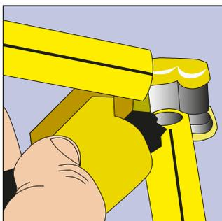
**1.** Para asegurar una correcta electrofundición, cortar el tubo con un cortatubo en un ángulo de 90°.
