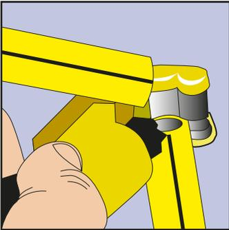
**2.** Cortar el tubo en forma perpendicular al eje, con corta-tubo.
