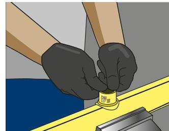
**5.** Retire el termofusor. Rápidamente y con exactitud presione la montura en el sector precalentado del caño y, sin girar, mantenga la presión durante 30 segundos. Deje enfriar la unión durante 30 segundos.
