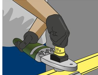
**4.** A continuación se calienta la montura, durante 30 segundos, sin retirar la boquilla del caño (calentamiento total del caño: 60 segundos).
