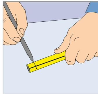
**3.** Marcar sobre cada extremo de los tubos a electrofundir la medida de penetración del mismo dentro del accesorio o cupla eléctrica (esta medida viene marcada en la cupla).
