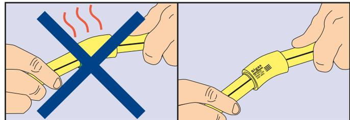
**4.** No someta las termofusiones terminadas a tensiones innecesarias (giros, movimientos, desplazamientos, esfuerzos) durante la etapa de enfriamiento. Los tubos Sigas Thermofusión no se deben doblar; para efectuar desvios utilice los accesorios que forman parte del sistema (CODOS A 90° y CODOS A 45°)
