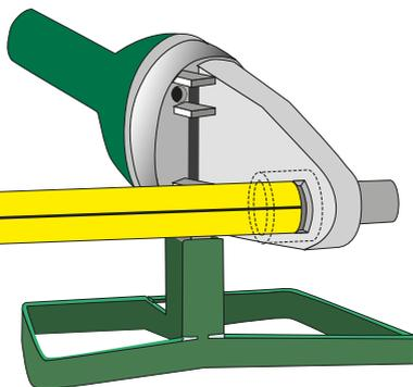
La fusión se realiza por contacto directo de las superficies a unir, que deben encontrarse en estado plastificado. Al terminar el proceso de fusión molecular se podrá observar en la unión un cordón visible formado por el propio arrastre del material plastificado. La temperatura en las boquillas puede oscilar entre 245°C y 275°C.
