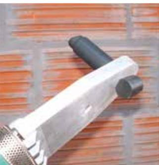
**3.** Se colocan en el Termofusor las boquillas especiales para monturas. La boquilla cóncava es para calentar el tubo y la boquilla convexa, para la montura.
