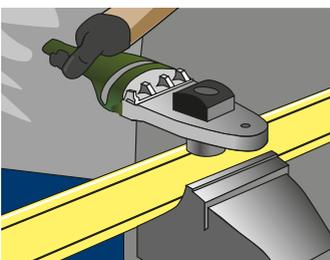
**3.** Colocar en el termofusor las boquillas especiales para monturas. Con la boquilla cóncava se calienta el caño y con la convexa, la montura. Primero, se calienta el caño por espacio de 30 segundos, hasta que se forme un anillo alrededor de la boquilla.
