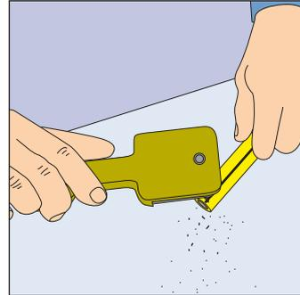
**2.** Raspar la superficie exterior del tubo a electrofundir. Limpiar esa superficie y la interior del accesorio con alcohol común.
