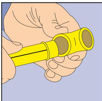
**9.** Inmediatamente después de sacarlos del termofusor, se debe introducir rápidamente el tubo en el accesorio.
