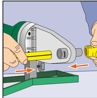
**6.** Introducir simultáneamente el tubo y el accesorio en las boquillas, en forma perpendicular a la plancha.
