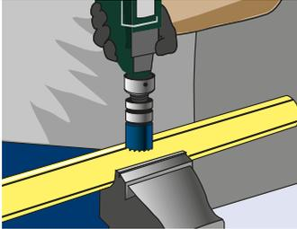
**1.** En el lugar donde se colocara la montura, perforar el caño con una mecha de copa del diámetro de salida de la montura a utilizar. El taladro debe estar en posición perpendicular al tubo para evitar que el agujero quede descentrado.
