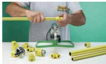
3. Unión por Thermofusión
