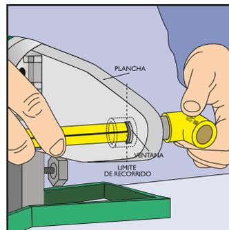
**7.** Para calentar los tubos de 20 y 25mm se utilizan boquillas hembra con ranuras. En estos casos la introducción de los tubos en sus respectivas boquillas debe llegar hasta el borde de la ventana (ranura) más cercano a la entrada de las
