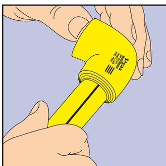
**10.** Frenar la introducción del tubo cuando se juntan los dos anillos que se forman con el corrimiento del polietileno. Dejar reposar cada termofusión® hasta que se enfríe totalmente (ver tabla I de pág.12).
