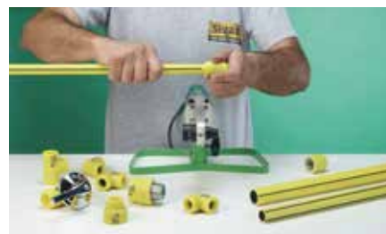
3. Unión por Termofusión
